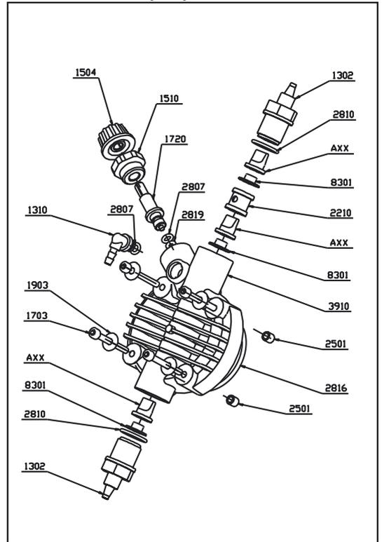
**Elettromagnete Completo - Complete Electromagnet**
